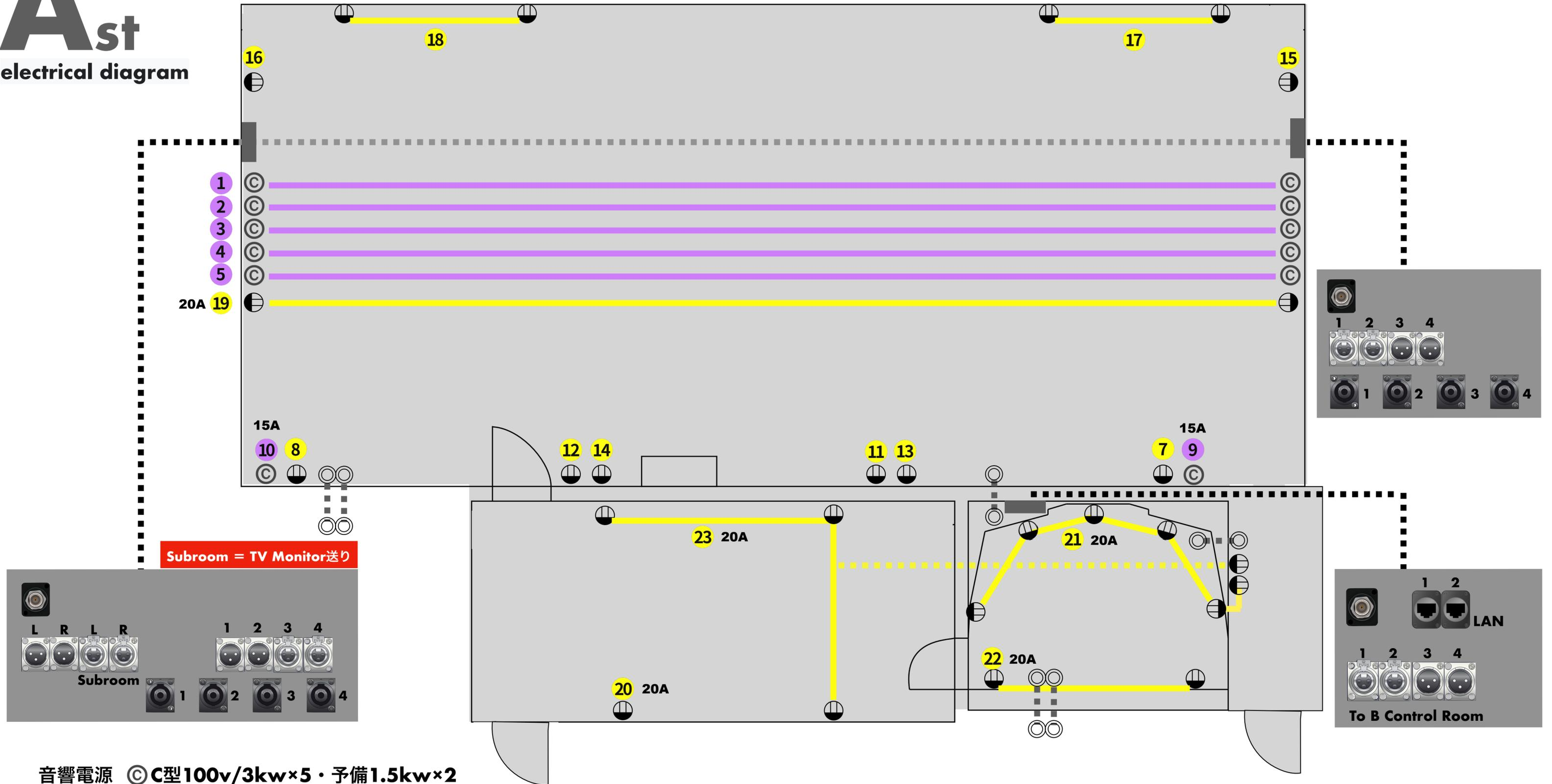
音響電源 © C型100v/3kw×5・予備1.5kw×2
